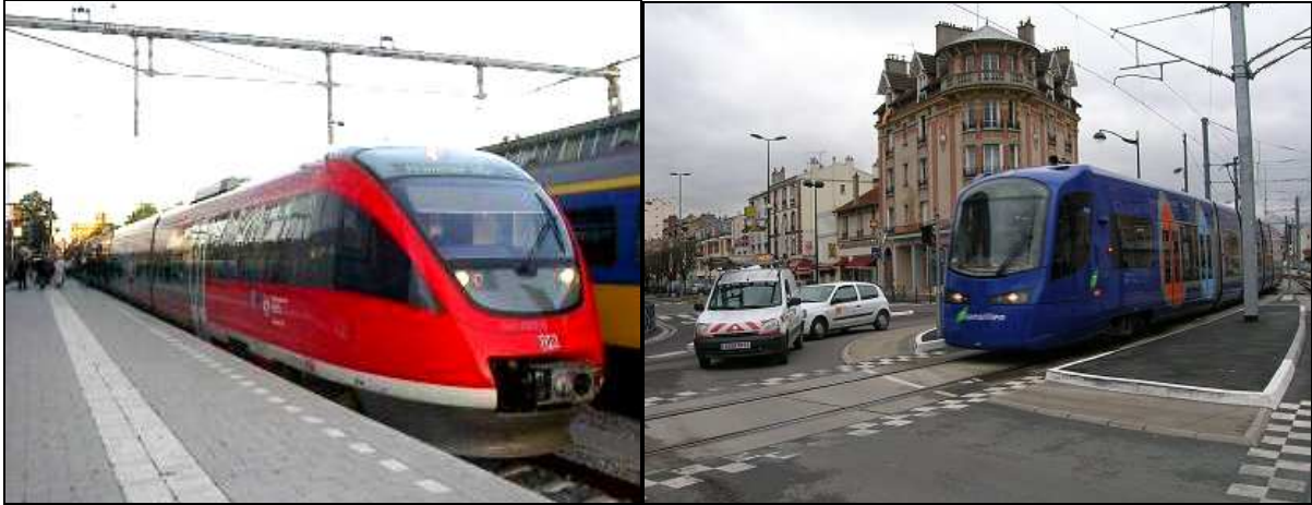
Figuur 7: Verschil tussen light train (links) en lightrail (rechts)
