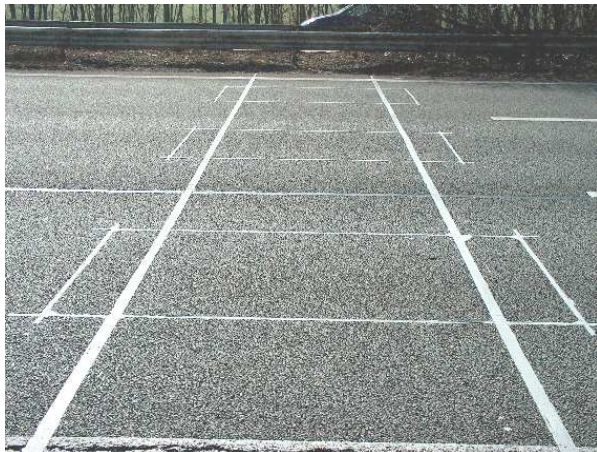
Boucles et barreaux piézo-céramiques (photo CRR)
