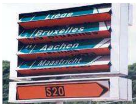
Figure 5 Panneau directionnel variable
