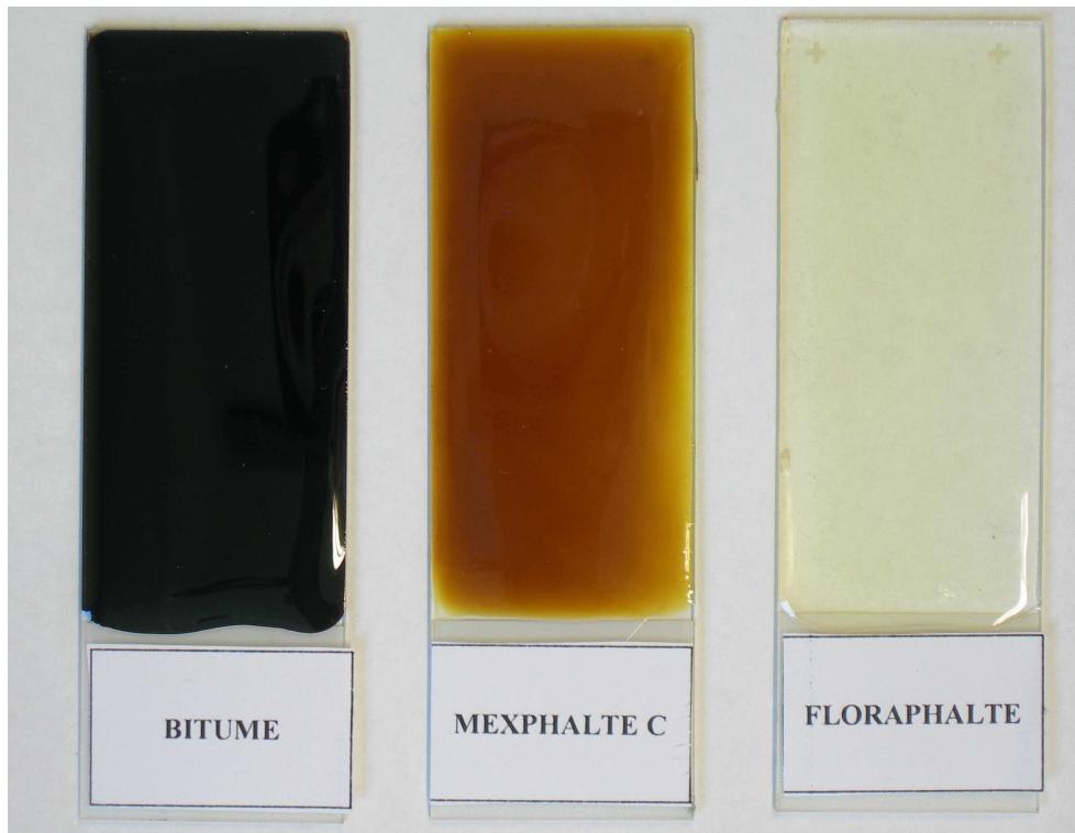
Figure 1 : Transparence comparée du bitume, du liant synthétique et du liant végétal
