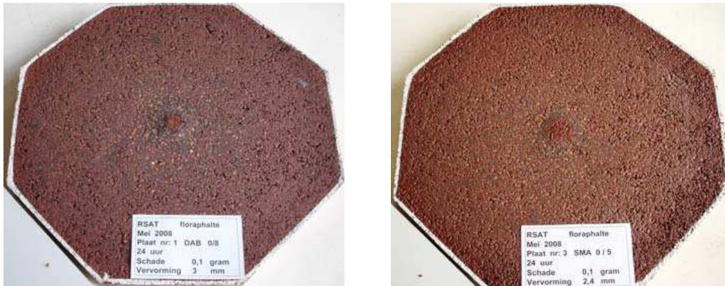
Figure 4 : Configuration du test RSAT et plaques de DAB et SMA après l'essai
