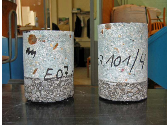
Figuur 8 : boorkernen ontnomen in de omgeving van de eindvoeg op de Ring van Antwerpen
