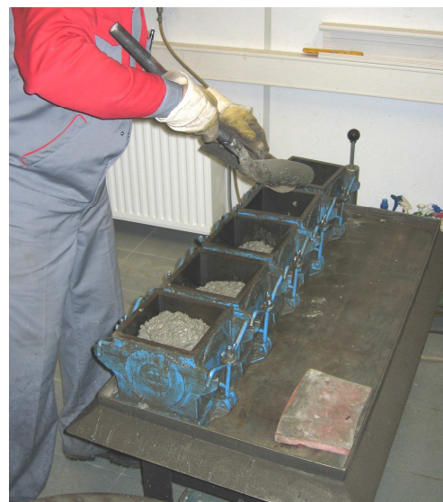
Figuur 2 vervaardiging van de betonkubussen.
