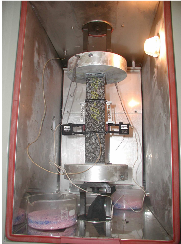
Figuur 1: Asfaltproefstuk geïnstalleerd voor het uitvoeren van de TSRST-proef.
