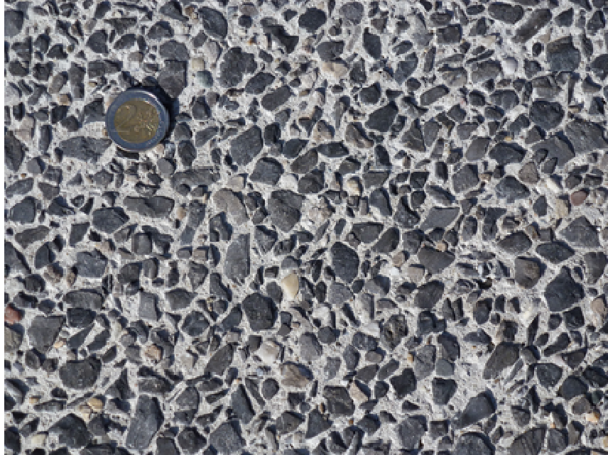
Illustration 3 : aspect obtenu après dénudage (Gravillon calcaire 6/14 et sans pigment de coloration)
