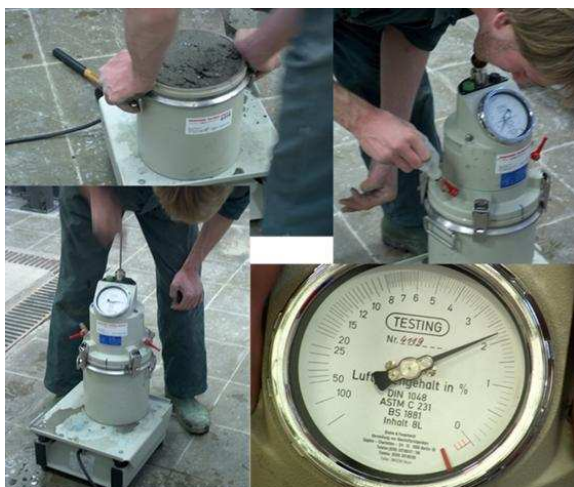
Figuur 1: Bepaling van luchtgehalte op vers beton volgens NBN EN 12350-7
