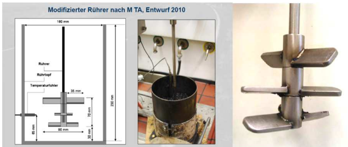
Figuur 4: Opstelling verwerkbaarheidstest AK 7.3.7. – MB-TA (Prof. Radenberg)
