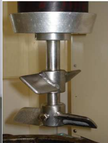
Figuur 3: Opstelling verwerkbaarheidstest IFM-VIS-GA (Prof. Schellenberg)
