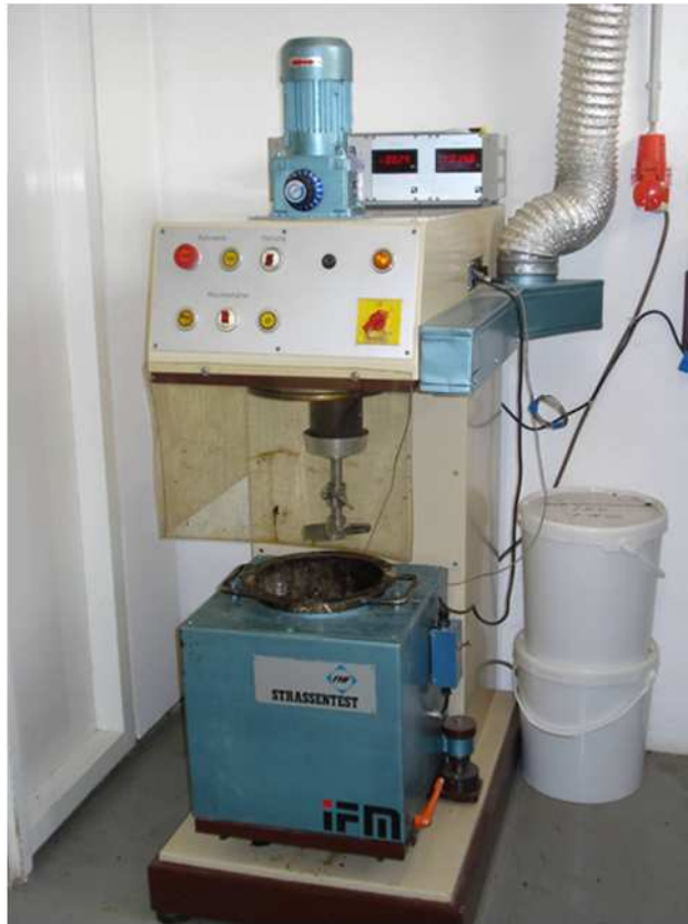
Figuur 3: Opstelling verwerkbaarheidstest IFM-VIS-GA (Prof. Schellenberg)
