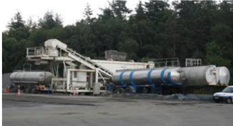
Photo 6 : centrale d'enrobage à l'émulsion
